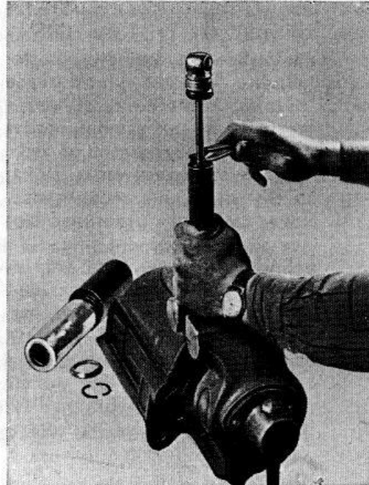
Rys. 57 Wykręcanie pokrywy amortyzatora
