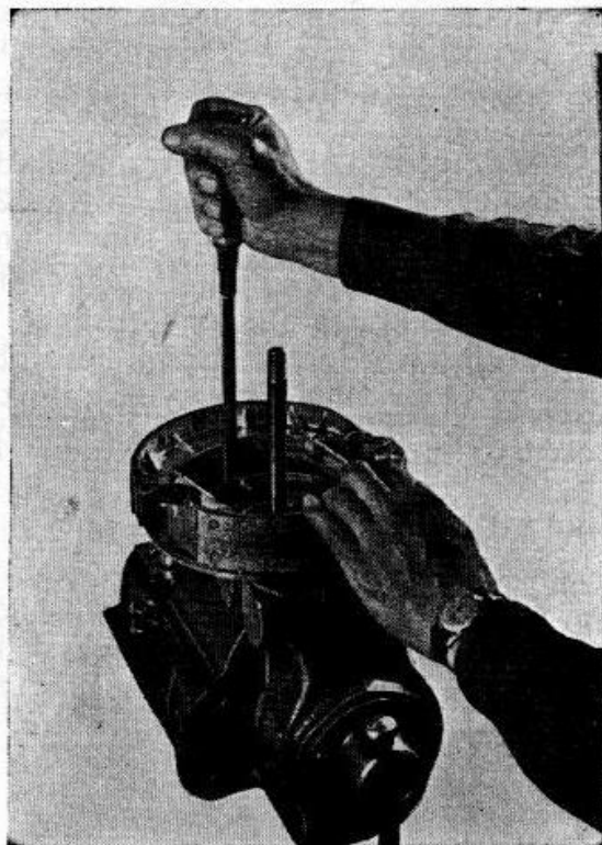
Rys. 46 Zdejmowanie szczęk hamulcowych
