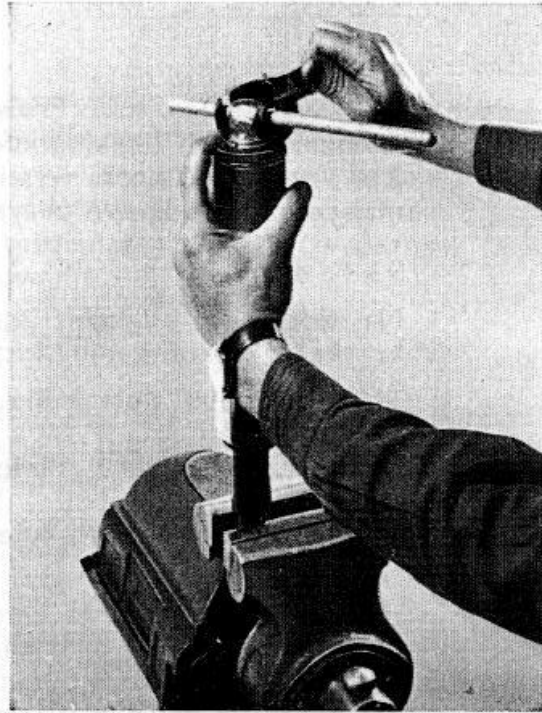
Rys. 56 Wyjmowanie zabezpieczeń sprężyny elementu resorującego
