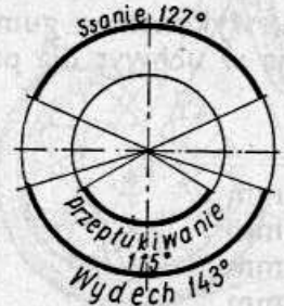
Rys. 4 Moc, jednostkowe zużycie paliwa silnika modelu TLF-250, o mocy 12 KM. Moc (N), moment obrotowy (M), jednostkowe zużycie paliwa (S) i wykres przełożeń (I) w funkcji prędkości obrotowej silnika; czasy otwarcia i zamykania kanałów
