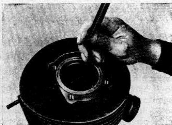
Rys. 13 Sprawdzenie luzu na zamku pierścienia tłokowego
