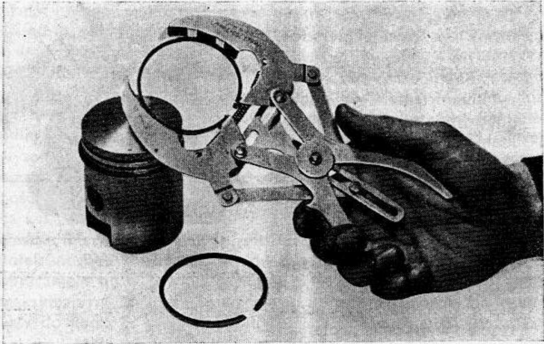
Rys. 15 Zdejmowanie i zakładanie pierścienia tłokowego
